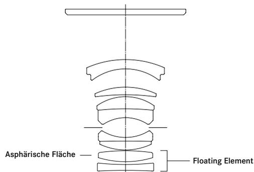
Dem Summarit-S 1:2,5/70 mm ASPH. kommt im Leica S-System die Rolle des Standard-Objektivs zu, dessen Bildwinkel dem eines 56-mm-Objektivs im Kleinbild entspricht. Damit sich dieses Objektiv für universelle Anwendungen empfiehlt, betrieben die Entwickler einen sehr hohen Aufwand, um höchste Abbildungsleistungen bereits bei offener Blende und bei allen Entfernungseinstellungen zu garantieren.
