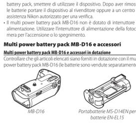
Il portabatterie MS-D14EN è inserito nel multi power battery pack MB-D16 al momento della spedizione. Vedere la sezione relativa all'inserimento delle batterie per informazioni su come rimuoverla.
