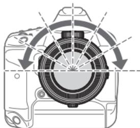
Der Drehmechanismus kann bis  $\pm 90^\circ$  gedreht werden. Das Objektiv klickt immer dann, wenn  $30^\circ$  erreicht sind, und rastet bei  $0^\circ$  und  $\pm 90^\circ$  ein.
