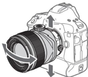
Verschwenk- und Verschieberichtungen bei rechtwinkliger TS-Drehung
