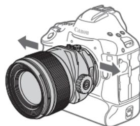
Verschieberichtung bei einer Drehung von  $90^\circ$ .
