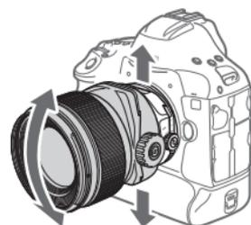
Verschwenk- und Verschieberichtungen bei paralleler TS-Drehung
