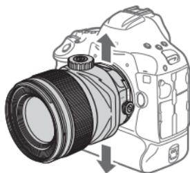
Verschieberichtung bei einer Drehung von  $0^\circ$ .
