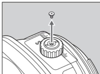
**1** Entfernen Sie die Verschiebeknopfschraube.
