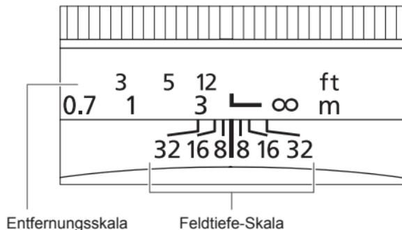
Die Feldtiefe ist der Bereich vor und hinter der Brennebene, in dem das Motiv scharf erscheint. Sie wird durch den Abstand zwischen den Linien der Feldtiefe-Skala unter der Entfernungsskala dargestellt. Die Zahlen auf der Skala geben den Blendenwert an.
