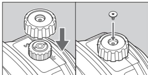
**2** Bringen Sie die Kappe an, indem Sie sie auf den Verschiebeknopf aufsetzen und mit der mitgelieferten Schraube befestigen.
