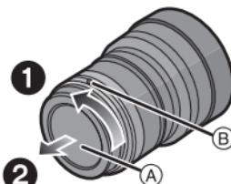
**2 Alignez les repères pour la mise en place de l'objectif (B) (marques rouges) sur le boîtier de l'appareil photo et sur l'objectif, puis tournez l'objectif dans le sens de la flèche jusqu'à ce que vous entendiez un déclic.**
